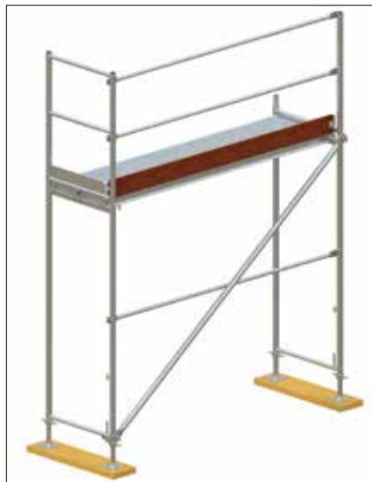
Rys. 1. Schemat rusztowania ramowego (bez pomostu komunikacyjnego)
