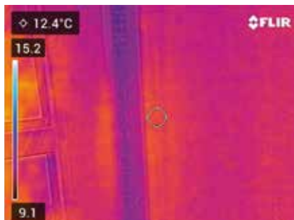
Fot. 17. Widok fragmentu budynku renowanego do standardu EnerPHit. Glik wewnętrzny wykonany klejem na siatce. „Ciepły” montaż okna (poza murem). Termogram obrazujący właściwą jakość termiczną styku połączenia ramy okna z ościeżnicą
