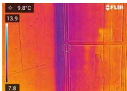
Fot. 16. Widok fragmentu budynku poddanego renowacji do standardu EnerPHit. Ocieplenie gliku wewnętrznego styropianem. „Ciepły” montaż okna (poza murem). Termogram obrazujący właściwą jakość termiczną styku połączenia ramy okna z ościeżnicą
