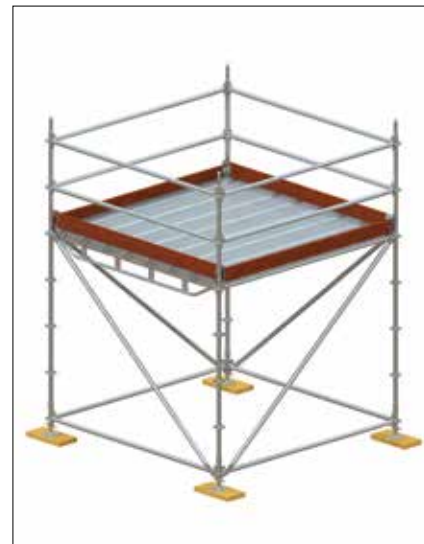
Rys. 2. Schemat rusztowania modułowego (bez pomostu komunikacyjnego)
