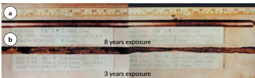
Fot. 2. Obrazy skorodowanych fragmentów uziomów pionowych: a) stalowego pomiedziowanego po ośmioletniej ekspozycji w gruncie, b) stalowego ocynkowanego po trzyletniej ekspozycji w gruncie (pH gruntu = 6,1–6,5) [14]
