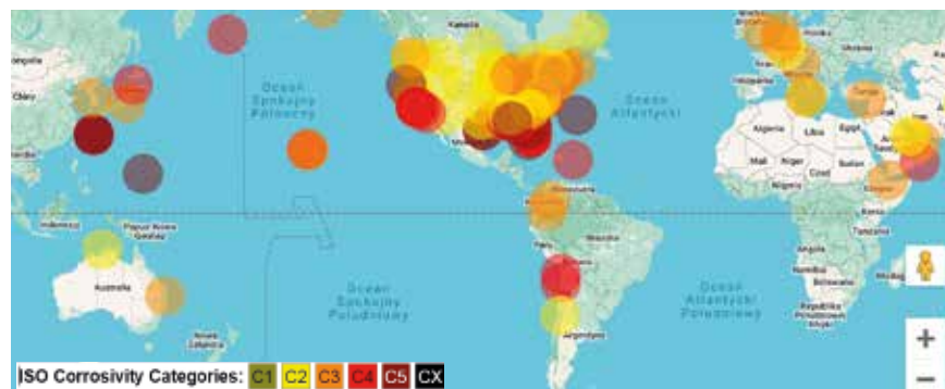
Rys. 2. Mapa lokalizacji miejsc w różnych kategoriach korozyjności określonych według normy ISO [9], utworzona przy wykorzystaniu Whole Building Design Guide Toolbox [11]
