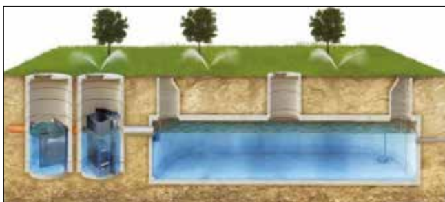
Rys. 1. Przykład zbiornika retencyjnego szczelnego [4]
