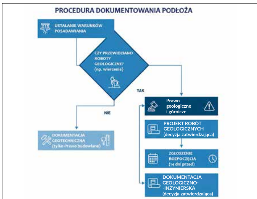
Rys. Procedura dokumentowania podłoża
