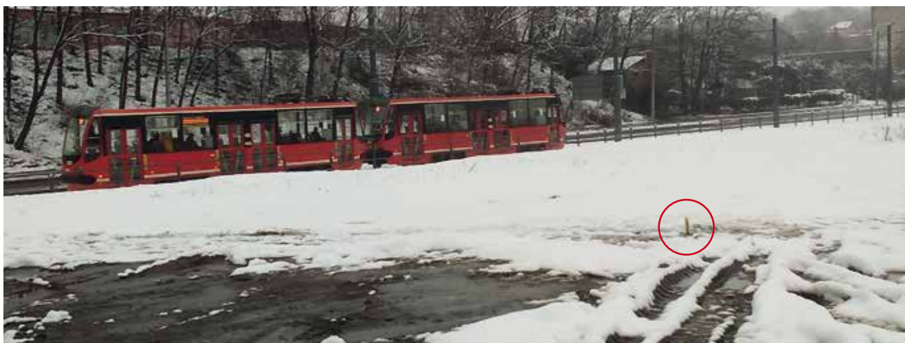
Fot. 3. Odjazd składu tramwaju w Sosnowcu podczas badania lokalnej, jednostkowej konduktancji przejścia szyny–ziemia. Na zbliżeniu widoczny jest żółty pręt – elektroda stojąca w gruncie podczas rejestracji potencjału
