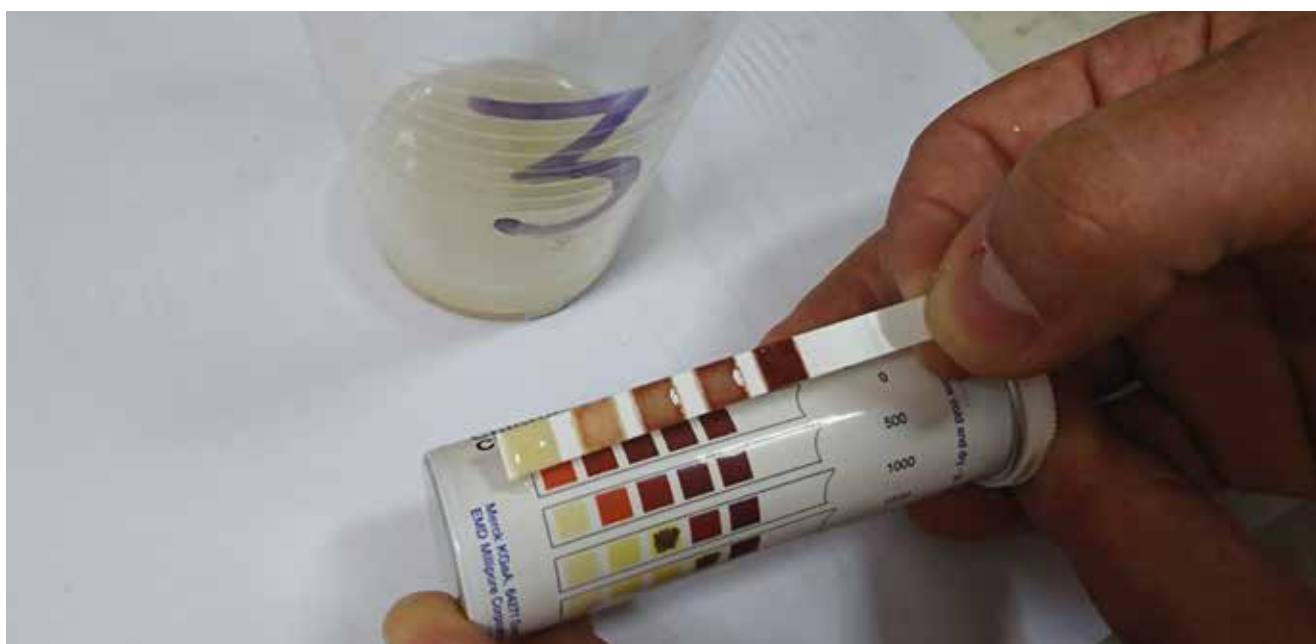
Fot. 10. Półilościowa analiza chlorków paskami wskaźnikowymi
