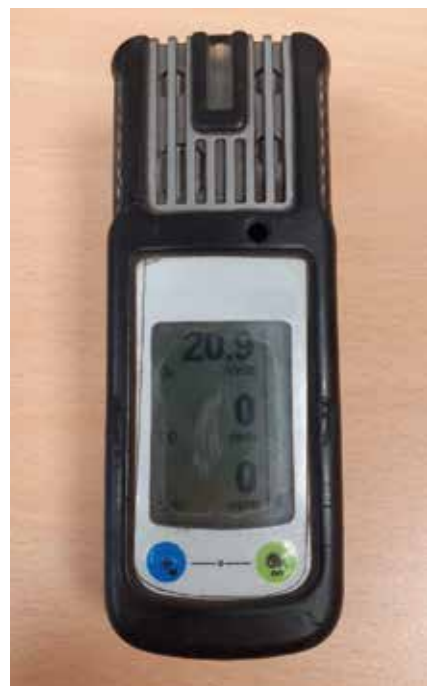
Fot. 1. Detektor przenośny, wielogazowy, do wykrywania O 2 , CO i NH 3
