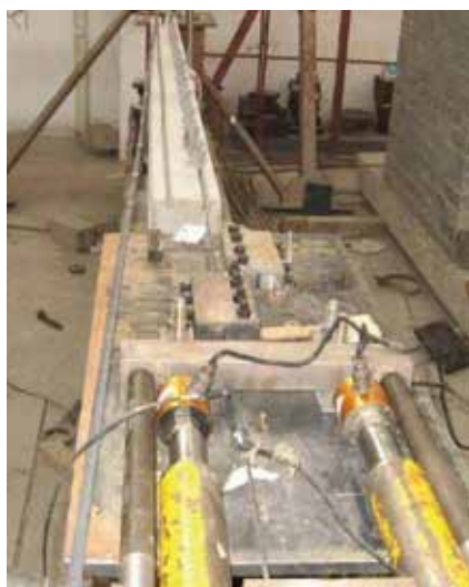
Fot. 5. Przykład realizacji pośredniego sprężania systemu NSMR [10]
