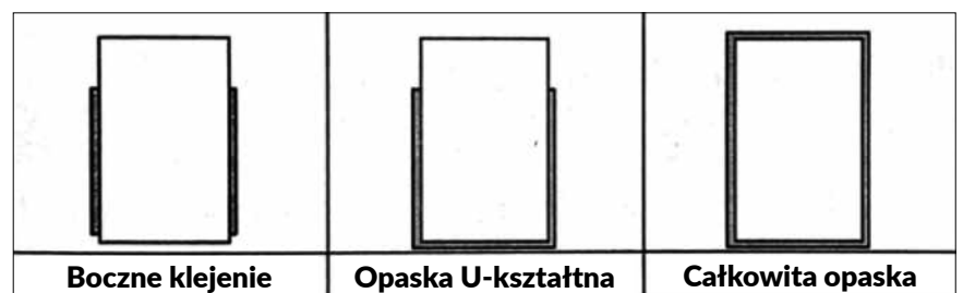
Rys. 9. Schemat wzmocnienia belki [12]
