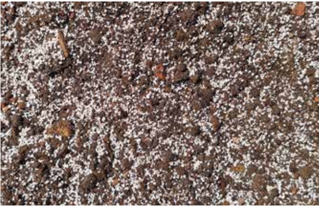
Fot. 5. Lekki substrat ekstensywny z dodatkiem kruszywa perlitowego pod maty rozchodnikowe
