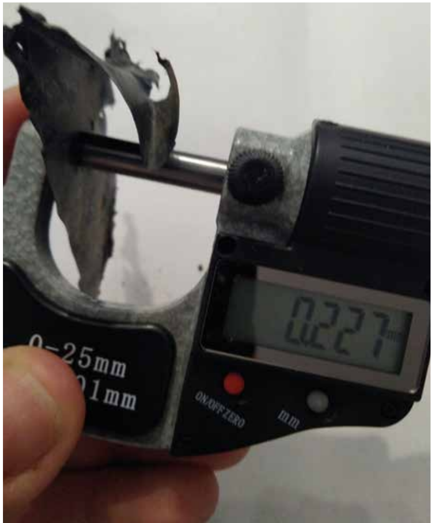
Fot. 4-5. Przykład błędnego zastosowania folii o grubości 0,2 mm jako izolacji przeciwwodnej pod płytą fundamentową
