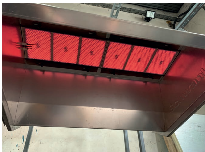
Fot. 3. Płyta promiennika ceramicznego rozgrzana do temperatury 1200°C
