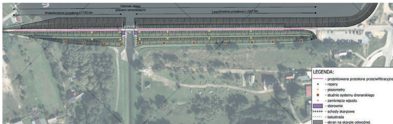
Fot. 5. Zapora czołowa zbiornika Cedzyna [13]
