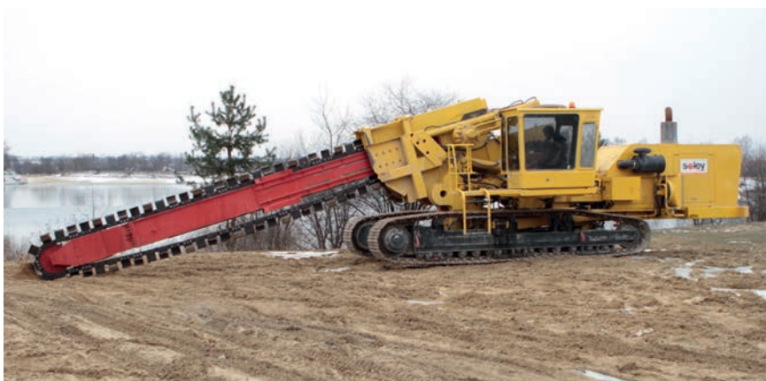
Fot. 4. Technologia CDMM do realizacji przesłon przeciwfiltracyjnych
