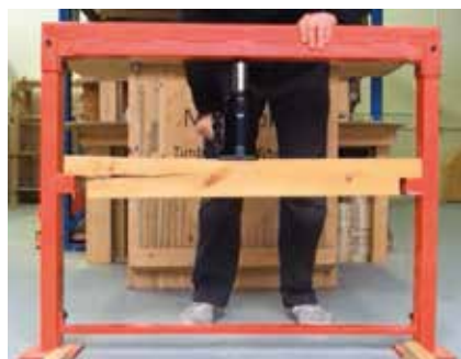
Fot. 2. Wpływ zastosowania łącznika prostopadłe do elementu w celu przejścia naprężeń rozciągających [22]
