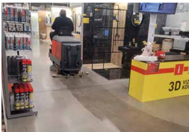
Fot. 14. Mycie powierzchni podłogi maszyną czyszcząco-zbierającą
