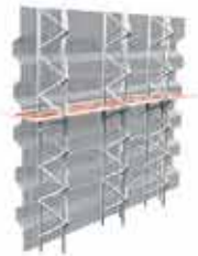
3 RECOSTAL® Przerwa robocza
