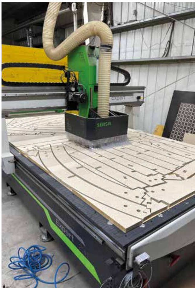
Fot. 1. Maszyna CNC w procesie wycinania prefabrykatów z płyt drewnopochodnych. Obróbka numeryczna umożliwia precyzyjne odwzorowanie kształtów projektowych, minimalizację odpadów i wysoką powtarzalność elementów systemów szalunkowych Doki
