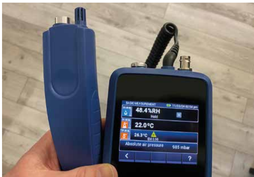
Fot. 1. Urządzenie do pomiaru wilgotności względnej oraz temperatury powietrza
