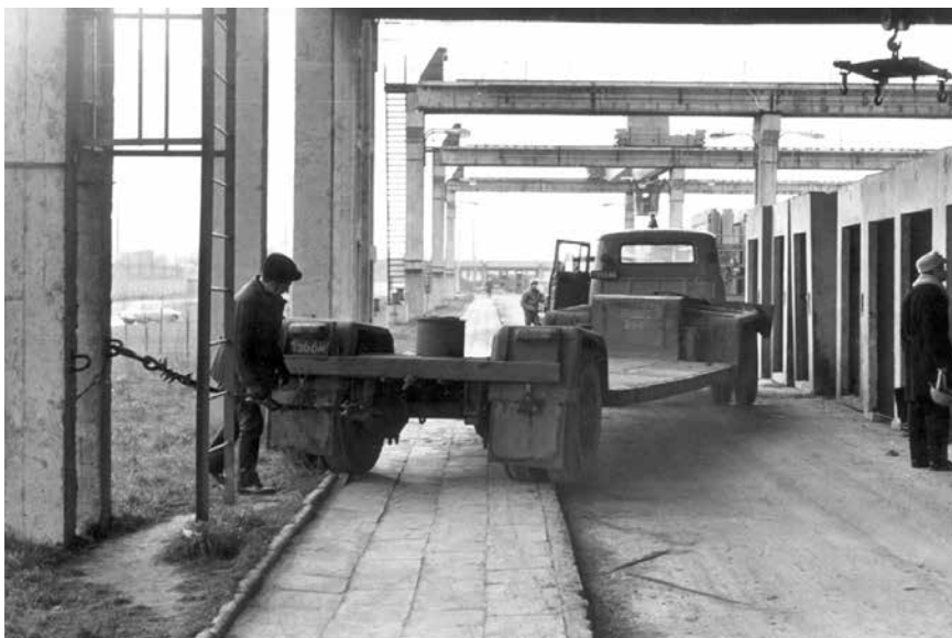
Fot. 1. Prostowanie zakleszczonego przegubu między ciągnikiem a naczepą przez przyłączenie naczepy do ażurowych słupów i szarpnięcie ciągnikiem
