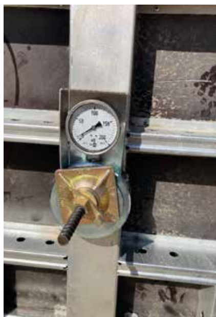
Fot. 3. Przyrząd zegarowy pozwalający określić w czasie rzeczywistym wartość siły rozciągającej w ściągu
