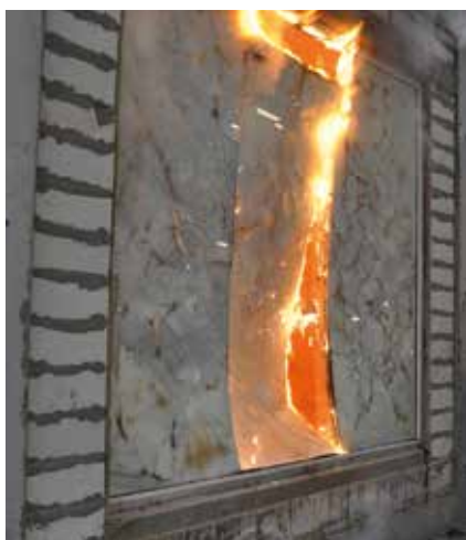
Fot. 2. Widok nienagrzewanej powierzchni elementu próbnego przeszklonej ściany bezsprosowej – utrata szczelności ogniowej
