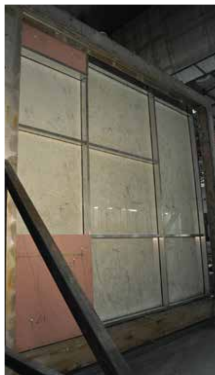
Fot. 4. Widok nienagrzewanej powierzchni elementu próbnego przeszklonej ściany osłonowej podczas badania w zakresie odporności ogniowej, w przypadku nagrzewania od zewnątrz
