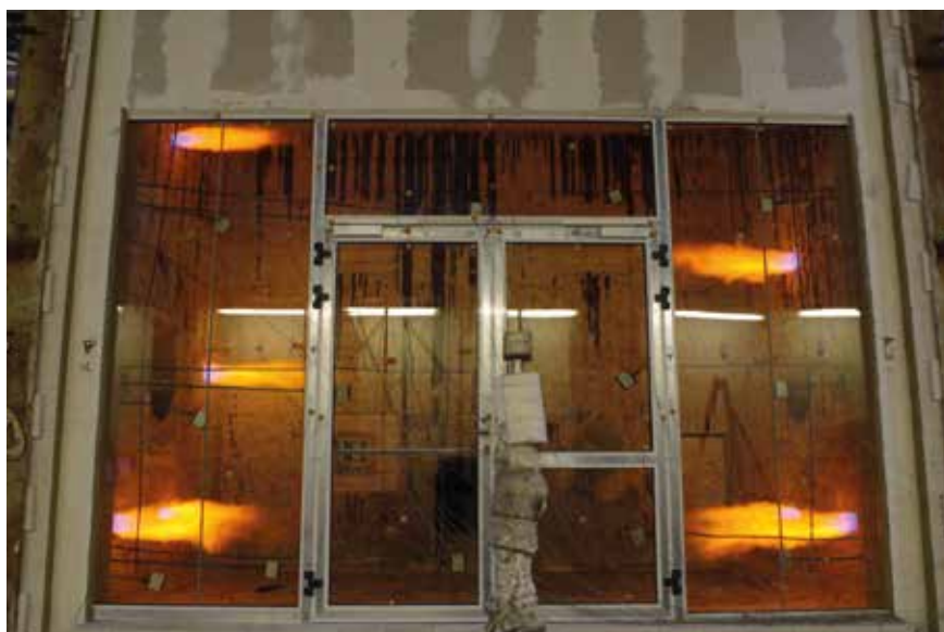
Fot. 5. Widok nienagrzewanej powierzchni drzwi dwuskrzydłowych zamontowanych w przeszklonej ścianie działowej bezsprosowej podczas badania w zakresie odporności ogniowej
