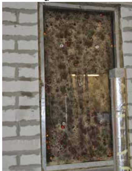
Rys. 1. Widok nienagrzewanej powierzchni przeszklonego okna nieotwieranego w trakcie badania w zakresie odporności ogniowej
