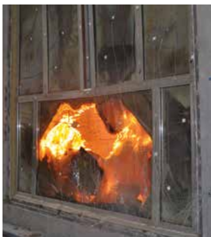
Fot. 1. Widok nienagrzewanej powierzchni elementu próbnego aluminiowej, przeszklonej ściany działowej – utrata szczelności ogniowej
