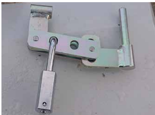
Fot. 6. Zamek typu wielodostęp umożliwia różnym operatorom założyć własne kłódki patentowe, by wejść na teren stacji
