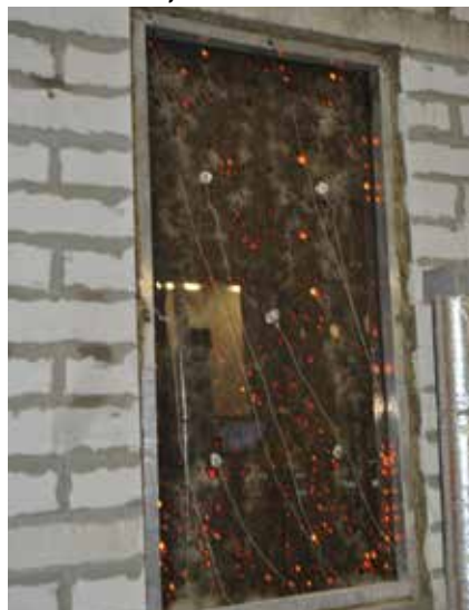
Rys. 1. Widok nienagrzewanej powierzchni przeszklonego okna nieotwieranego w trakcie badania w zakresie odporności ogniowej
