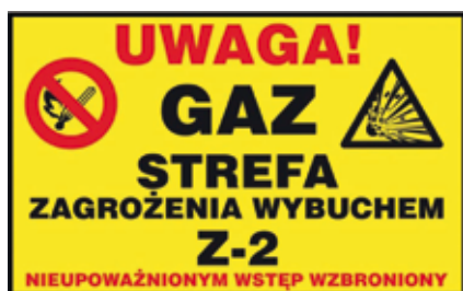
Rys. 1. Przykładowy znak ostrzegawczy informujący o możliwości wystąpienia atmosfery wybuchowej
