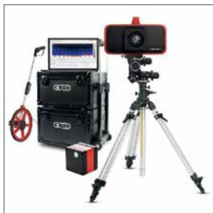
Fot. 2. Mobilny system pomiarowy w pełni przystosowany do pomiarów luminancji dróg i ulic [12]
