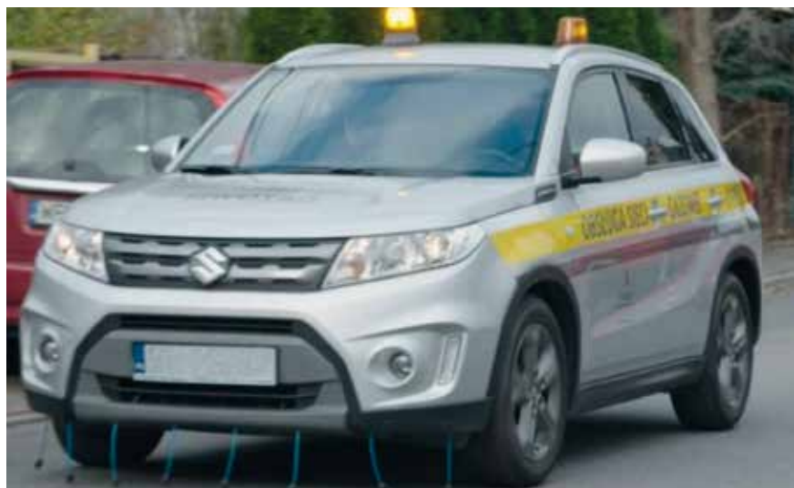
Fot. 1. Samochód przystosowany do wykonywania kontroli dywanowych
