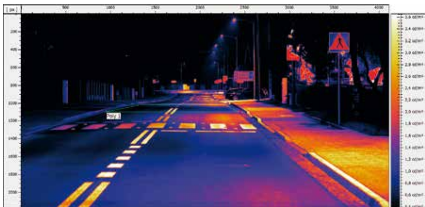
Rys. 5. Rozkład luminancji na drodze uzyskany na podstawie pomiaru matrycowym miernikiem luminancji i przy wykorzystaniu specjalistycznego oprogramowania [13]
