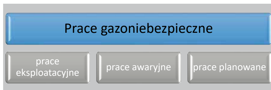
Rys. 2. Podział prac gazoniebezpiecznych
