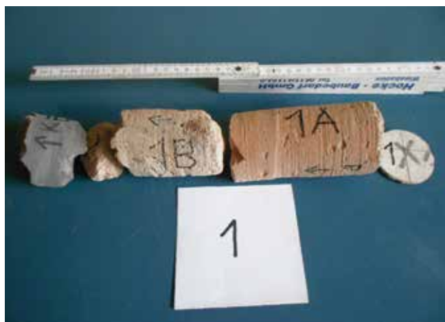
Fot. 3–4. Przykładowe pobrane próbki tynków: na podłożu ceglanym (3) i kamiennym (4)
