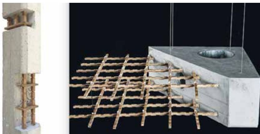
Fot. 8. Bambus jako zbrojenie [14]
