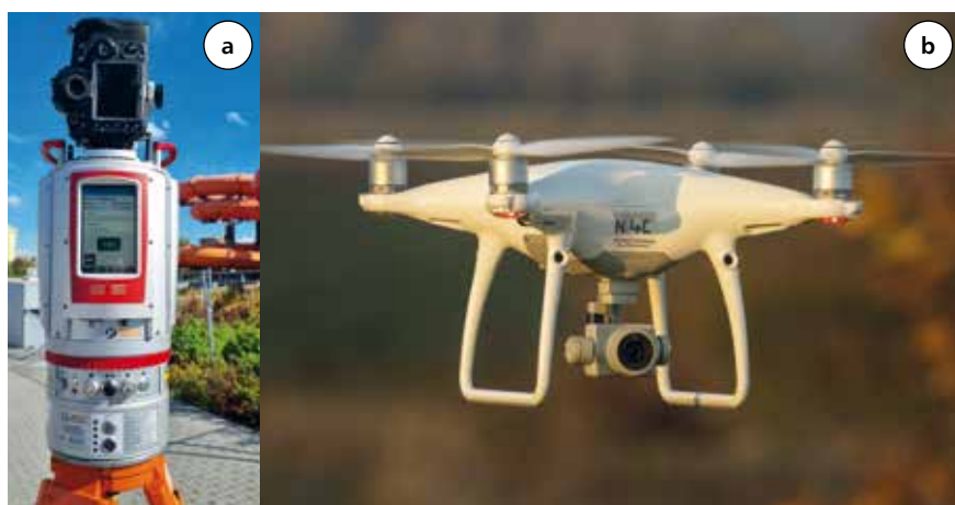
Fot. 1. Narzędzia wspomagające proces inwentaryzacji obiektów budowlanych: a) skaner laserowy, b) bezzałogowy statek powietrzny
