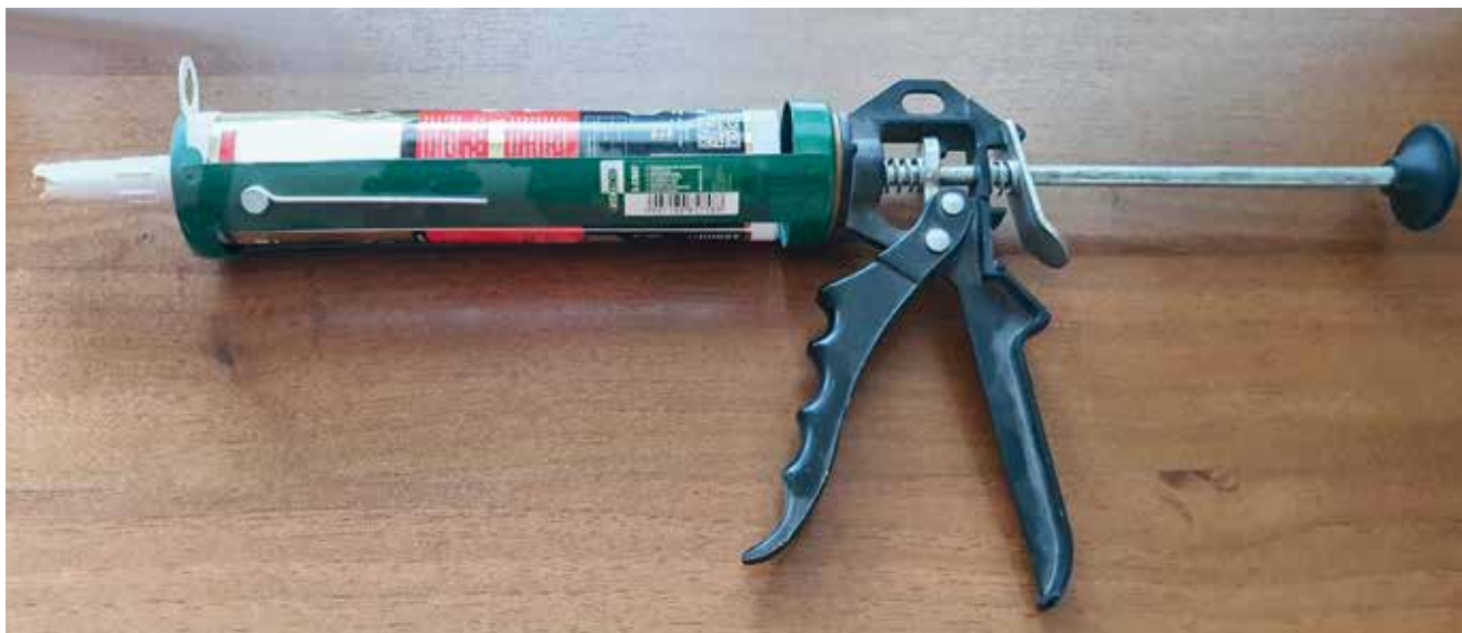
Fot. 1. Przykładowy kształt wyciskacza do kitów z zamontowanym kartuszem wypełnionym kitem
