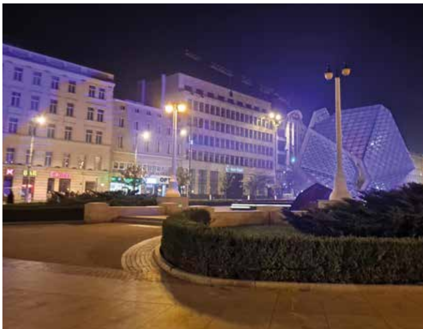
Fot. 8. Widoczna na elewacji budynku ucieczka światła poza oświetlany obiekt
