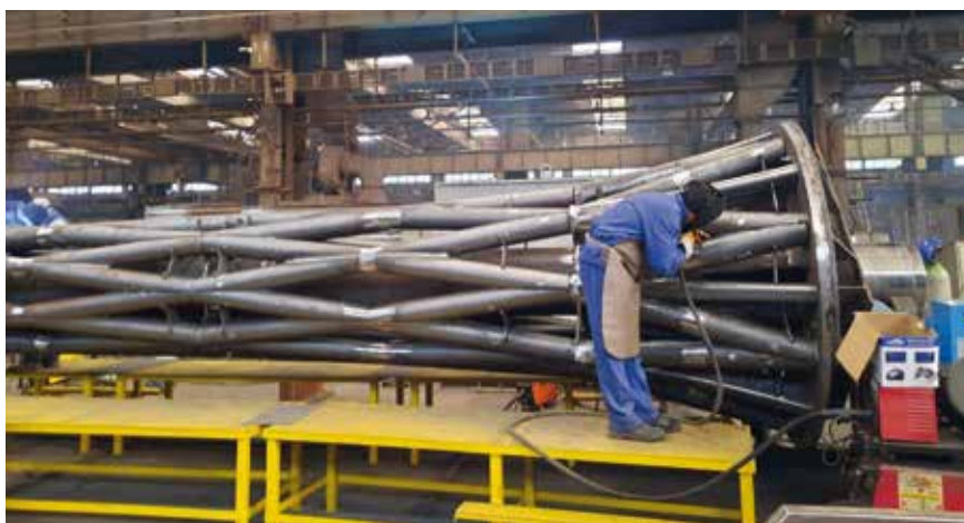
Fot. 2. Widok dolnej części słupa w trakcie procesu produkcji [5]
