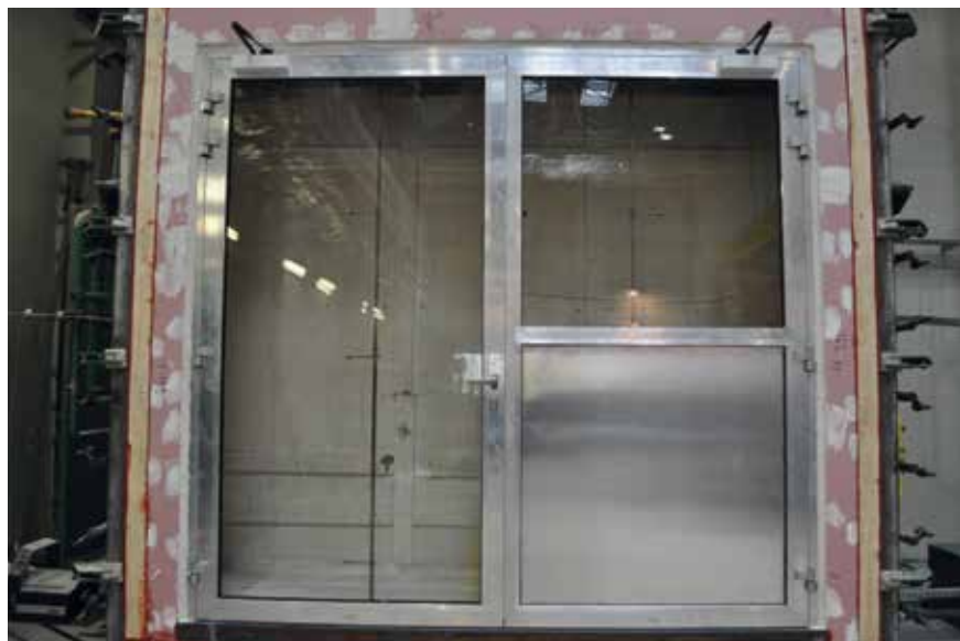
Fot. 1. Dwuskrzydłowe, aluminiowe, profilowe drzwi zamontowane w standardowej konstrukcji mocującej w trakcie badania w zakresie dymoszczelności
