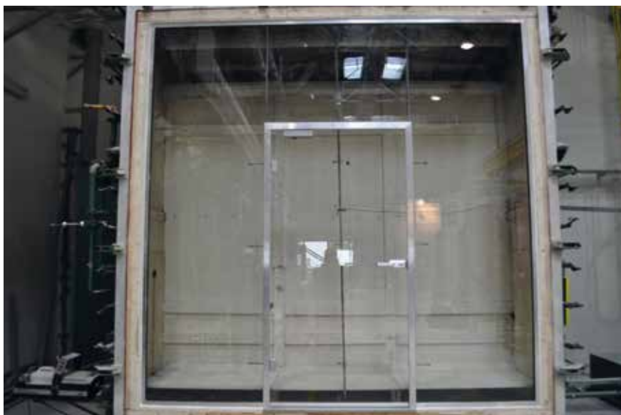
Fot. 2. Jednoskrzydłowe, aluminiowe, profilowe drzwi zamontowane w konstrukcji uzupełniającej podczas badania w zakresie dymoszczelności
