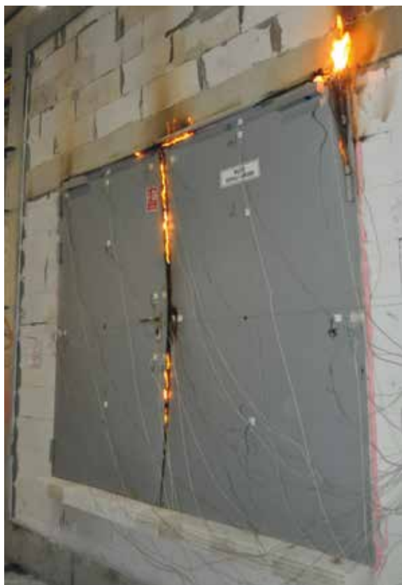
Fot. 3. Widok nienagrzewanej powierzchni drzwi przeciwpożarowych w 25. min badania w zakresie odporności ogniowej
