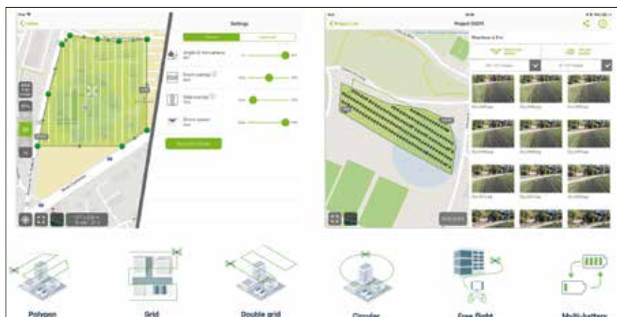
Rys. 1. Możliwości programowania lotu BSP w programie Pix4Dcapture [5]
