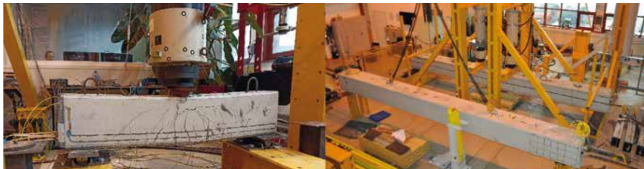
Fot. 1. Widok belki MS1(b) podczas badań oraz belek K1(b) i K2(z) w trakcie przygotowań do badań
