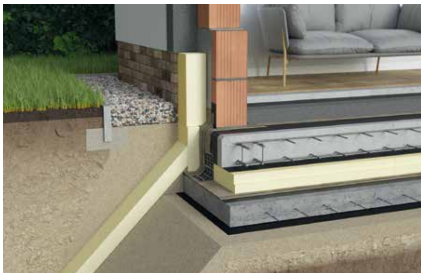
Rys. 6. Schemat hydroizolacji i termoizolacji budynku niepodpiwniczonego, posadowionego na płycie, będący połączeniem wariantów pokazanych na rys. 5 [15]
