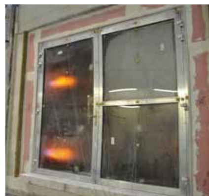
Fot. 2. Dwuskrzydłowe, aluminiowe, profilowe drzwi zamontowane w standardowej, podatnej konstrukcji mocującej w trakcie badania w zakresie odporności ogniowej
