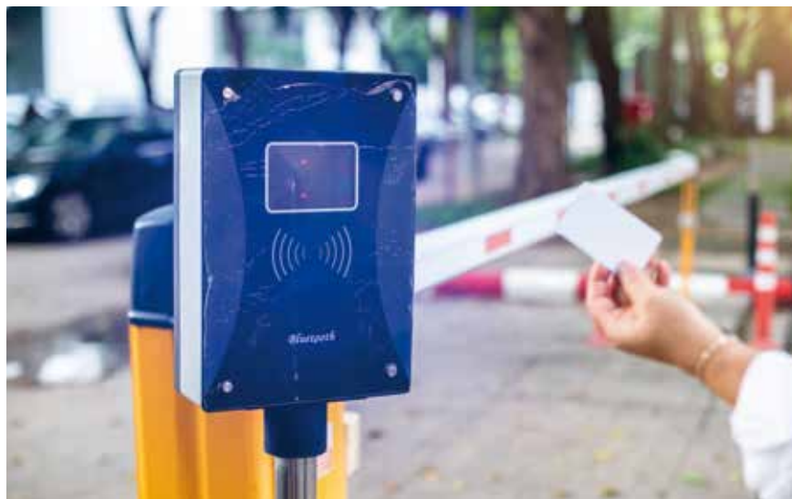
Fot. 5. Uprawnienia dostępu w przypadku bram i szlabanów mogą być weryfikowane za pomocą identyfikatorów, np. kart czy naklejek RFID, lub przez rozpoznawanie tablic rejestracyjnych
