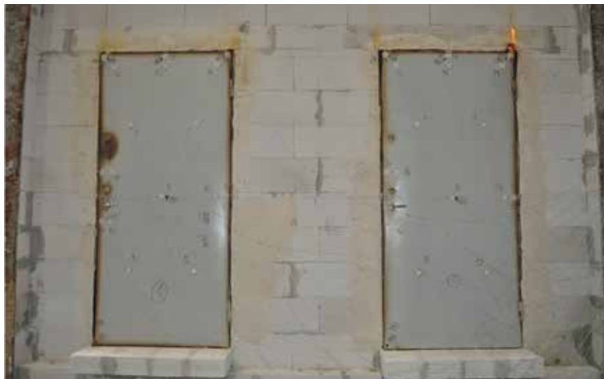
Fot. 1. Jednoskrzydłowe, stalowe drzwi płaskie zamontowane w standardowej sztywnej konstrukcji mocującej w trakcie badania w zakresie odporności ogniowej
