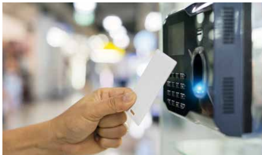
Fot. 1. Identyfikatory w postaci kart magnetycznych, zbliżeniowych lub czipowych zapewniają średni stopień zabezpieczenia kontroli dostępu
