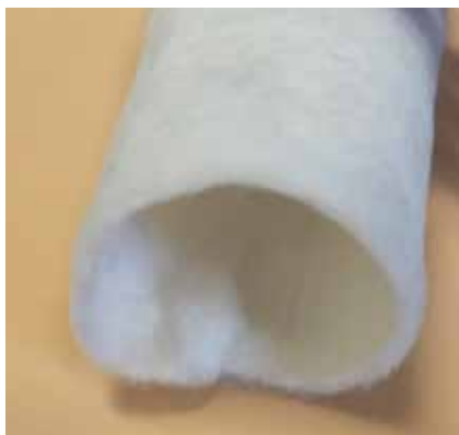
Fot. 1. Przykładowa mata aerożelowa o grubości 5 mm
