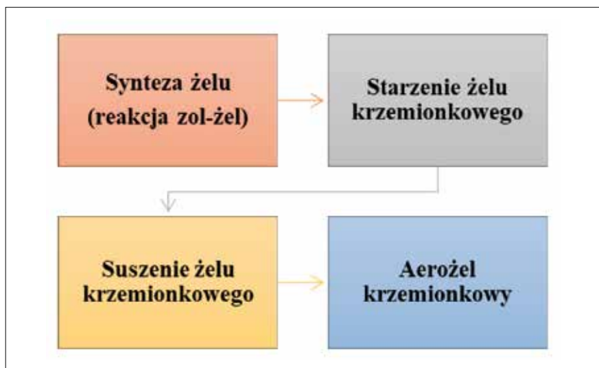
Rys. 2. Etapy syntezy aerożelu krzemionkowego [8]
