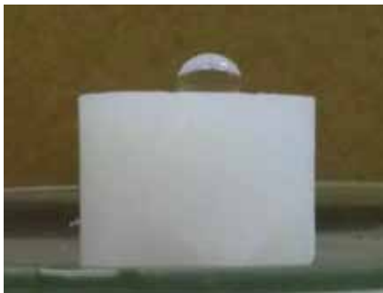
Fot. 4. Wysoki stopień hydrofobowości aerożelu krzemionkowego
