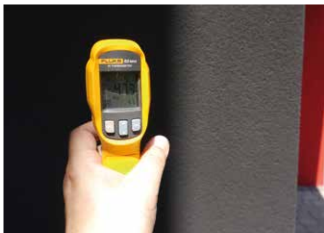
Fot. 6, 7. Różnica w temperaturze tynku w ciemnym kolorze na powierzchni zacienionej i nasłonecznionej
