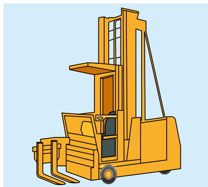
Rys. 1. Wózek jezdniowy podnośnikowy z mechanicznym napędem podnoszenia, z operatorem podnoszoną wraz z ładunkiem
