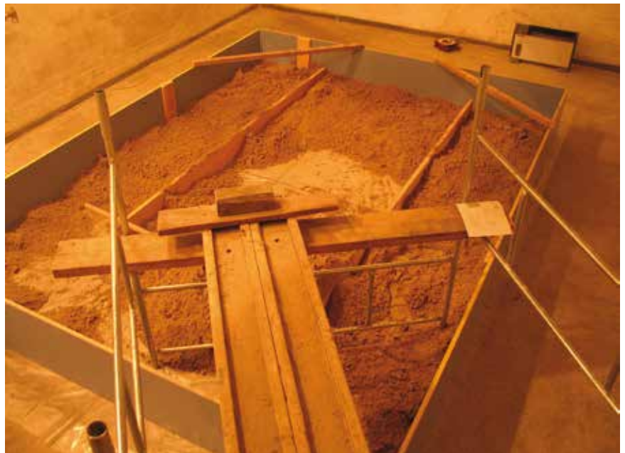
Fot. 1. Widok stanowiska przygotowanego do przebadania przykładowej próbki ekranu akustycznego w postaci gabionów. Próbka ułożona została w ramie drewnianej odbijającej dźwięk [5]
