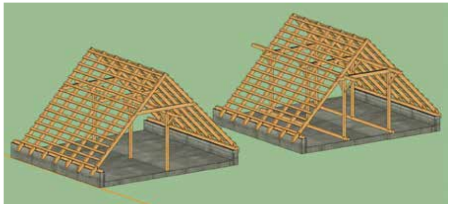
Rys. 1. Tradycyjne konstrukcje dachów (w zależności od konstrukcji ścian i stropów – z podwalną lub bez)
