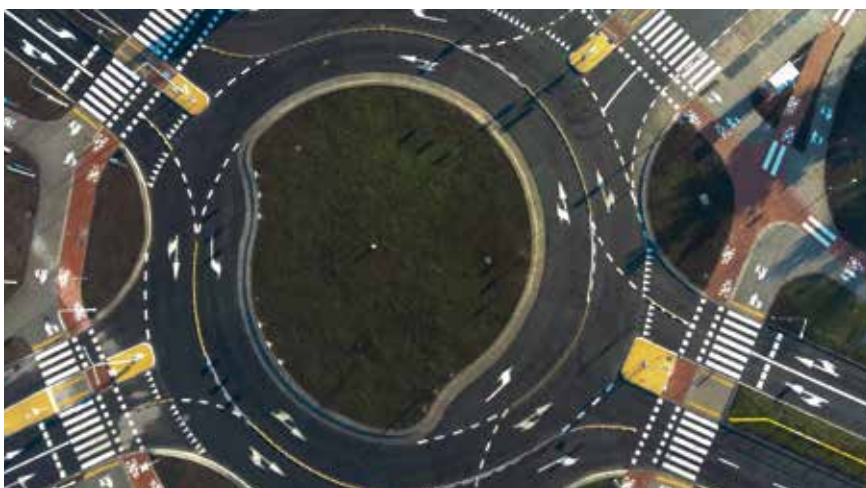
Fot. 3. Rondo turbinowe na połączeniu ul. Górnicy, Poznańskiej, Staszica i Głępa w Inowrocławiu [5]
