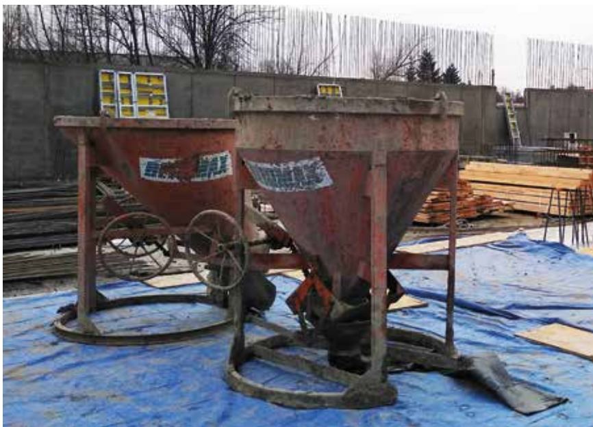
Fot. 3. Przykłady stosowanych pojemników na beton mocowanych do żurawia
