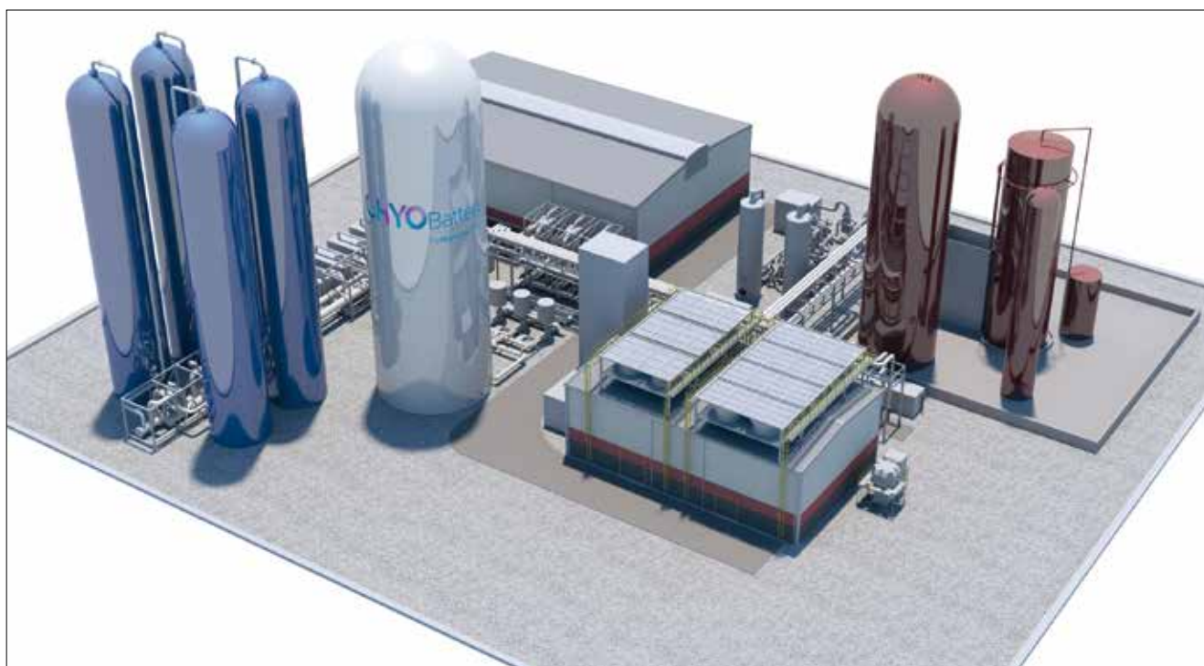
Rys. 2. Przykładowa konfiguracja kriogenicznego magazynu energii CryoBATTERY w technologii CAES o mocy znamionowej 50 MW i pojemności 250 MWh brytyjskiej firmy Highview Power
