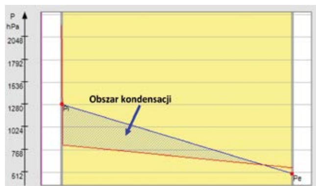
Rys. 5. Wykres prężności pary wodnej w stropodachu pełnym, stan istniejący. Klimat zewnętrzny – Warszawa, mikroklimat – pomieszczenie mieszkalne, klasa III III [1]
