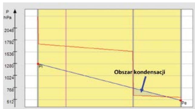
Rys. 6. Wykres prężności pary wodnej w stropodachu pełnym, po dociepleniu styropapą (styropian 20 cm). Klimat zewnętrzny – Warszawa, mikroklimat – pomieszczenie mieszkalne, klasa III III [1]
