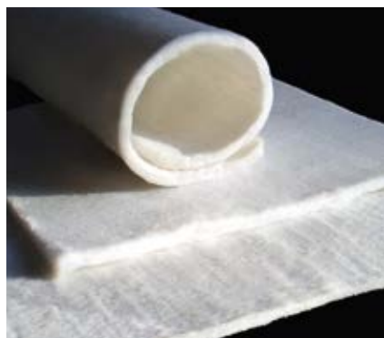
Rys. 9. Przykładowa mata aerożelowa o współczynniku przewodzenia ciepła \lambda = 0,012\text{--}0,018 \text{ W}/(\text{m}\cdot\text{K}) [3, 5]
