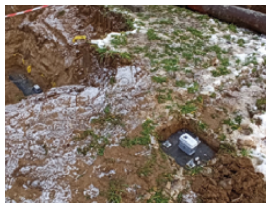
Fot. 1. Pomiar drgań – badania porównawcze na gruncie i na gazociągu
