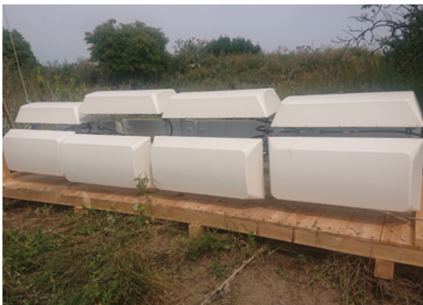
Fot. 4. Antena nadawcza przed instalacją, standard DVB-T2
