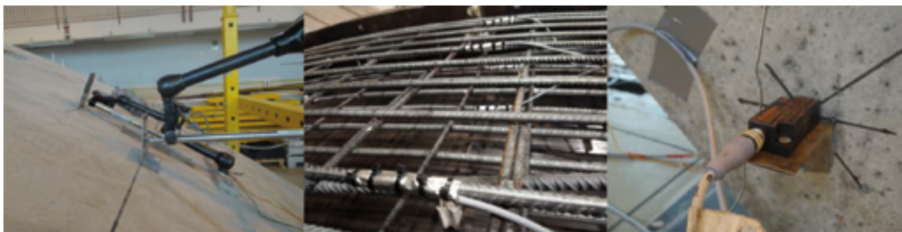
Fot. 3. Czujniki indukcyjne, tensometry i inklinometry zamocowane do konstrukcji
