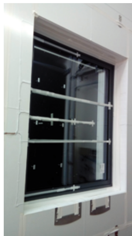
Zamontowane okno na stanowisku do badań
