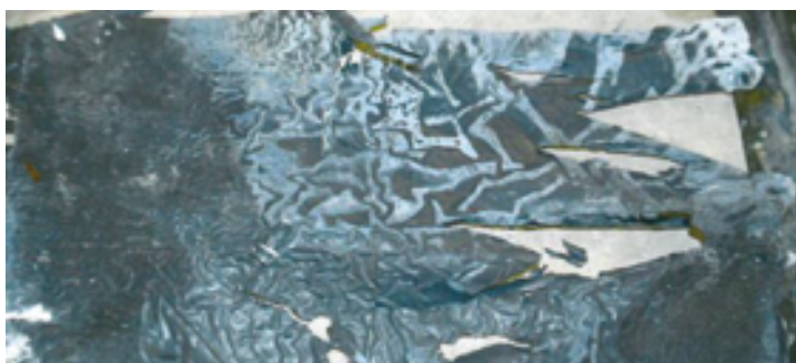
Fot. 2. Uszkodzone fragmenty folii pobranych z przekrycia dachowego po dwóch latach eksploatacji
