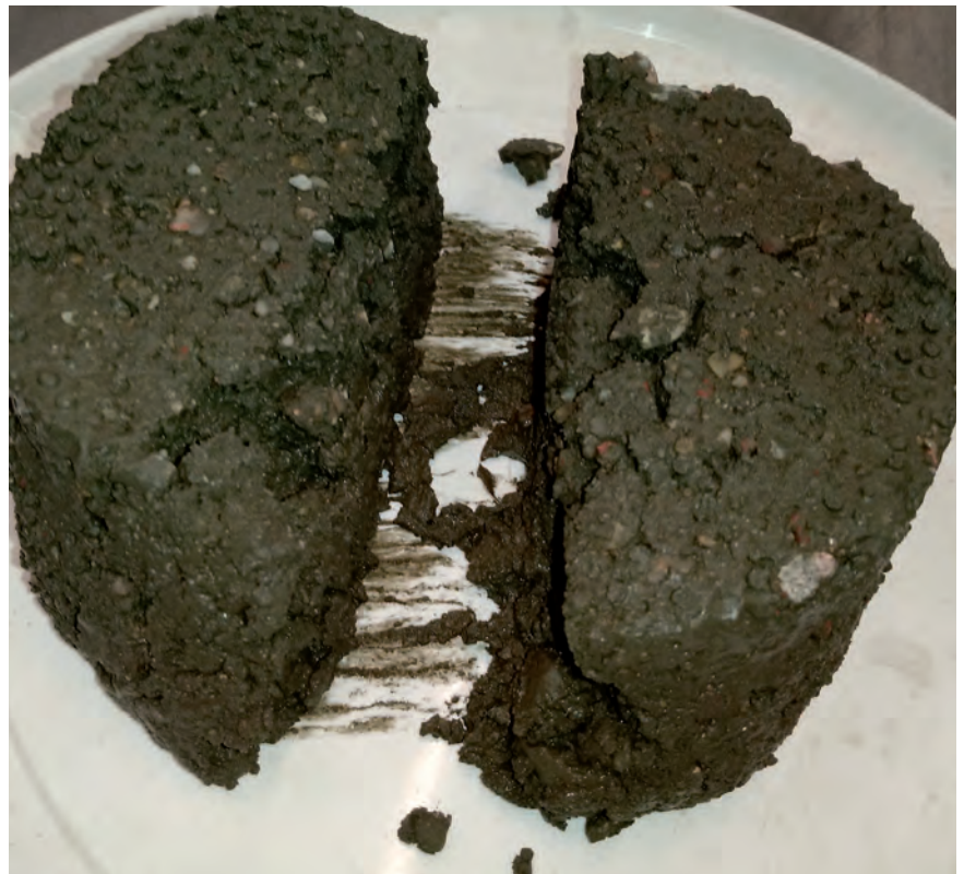
Fot. 4. Mieszanka po badaniu wymywania z domieszki stabilizującej
