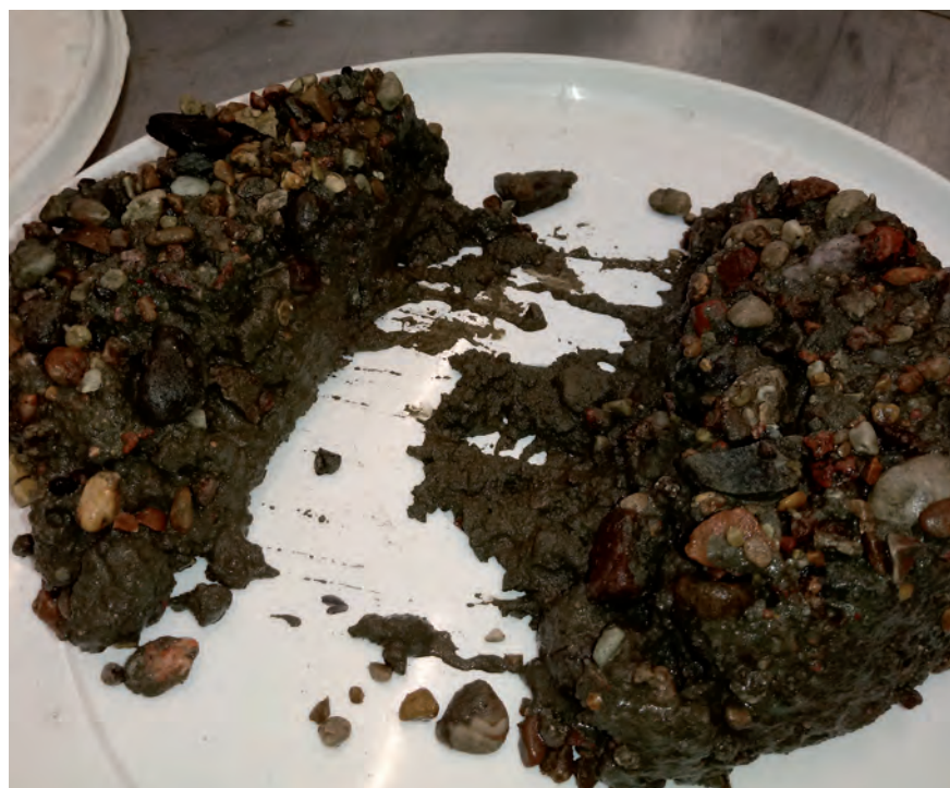
Fot. 3. Mieszanka po badaniu wymywania bez domieszki stabilizującej
