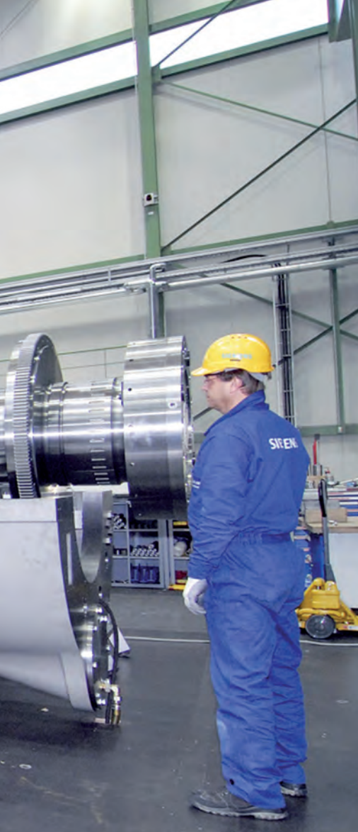
Fot. 1. Energetyczna turbina gazowa typu H firmy Siemens Energy przeznaczona dla bloku gazowo-parowego o wysokiej sprawności w Guangzhou w Chinach
