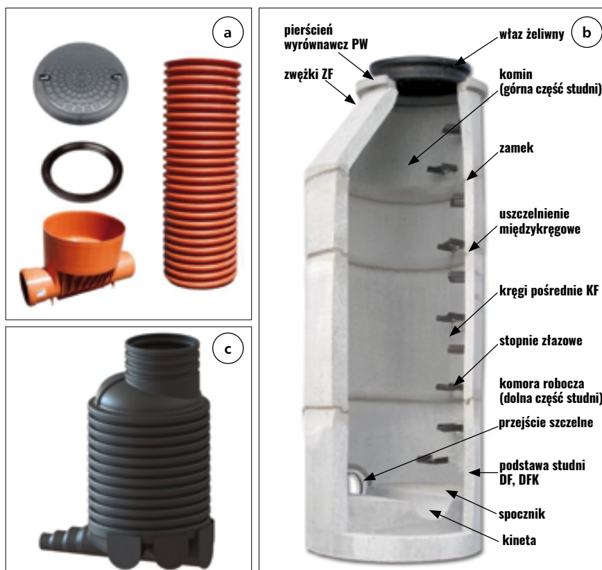
Fot. 4. Studnie kanalizacyjne: a) z PVC wraz z elementami, które wchodzi w jej skład; b) zbiorcza betonowa; c) monolityczna wykonana z polietylenu
