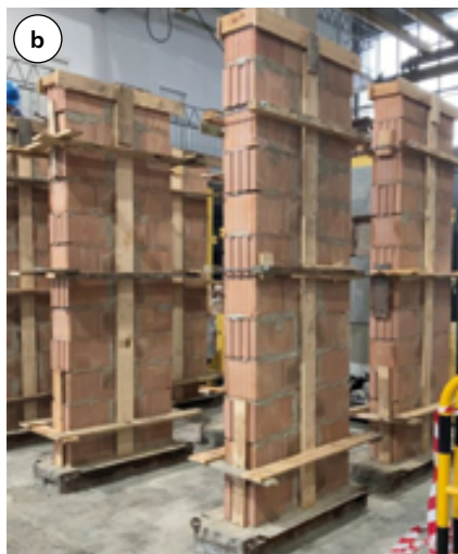
Fot. 1. Widok elementów próbnych do badań wytrzymałościowych: a) elementy typu I, b) elementy typu II
