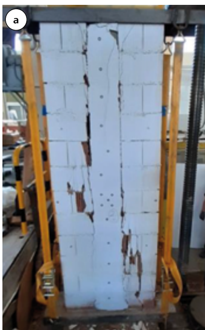
Fot. 4. Widok zniszczonych murów po badaniu wytrzymałościowym: a) typu I, b) typu II
