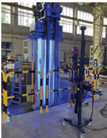
Fot. 3. Widok elementu próbnego typu I i optycznego systemu pomiarowego Aramis Adjustable 12M
