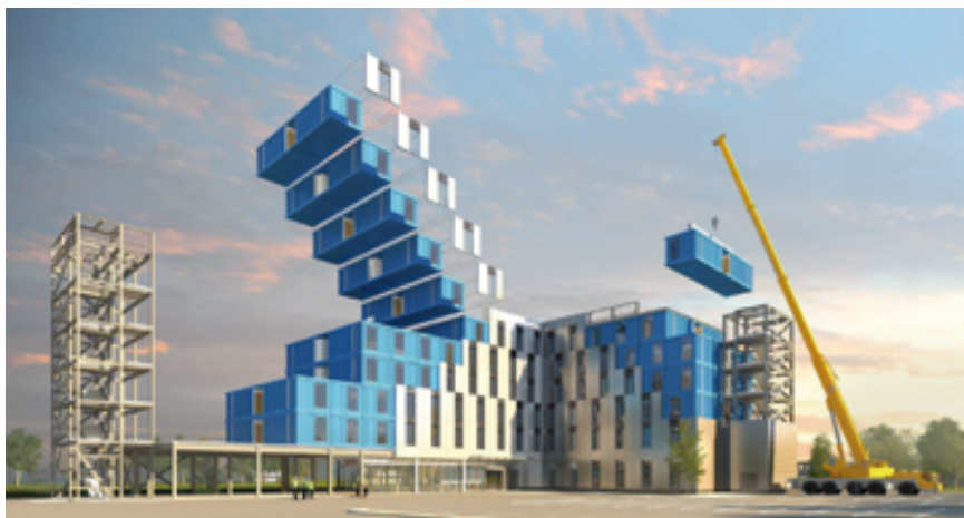
Rys. 2. Schemat montażu budynku modułowego ( https://www.chapmantaylor.com )
