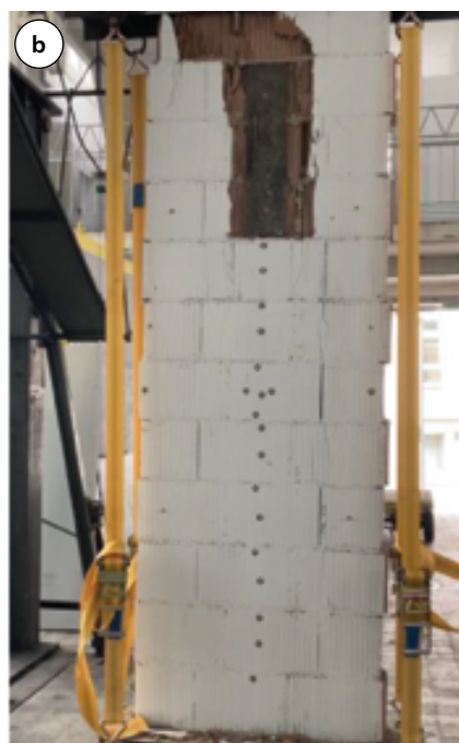
Fot. 4. Widok zniszczonych murów po badaniu wytrzymałościowym: a) typu I, b) typu II
