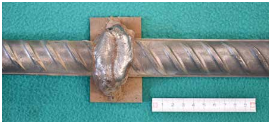
Fot. 1. Doczołowe złącze spawane na podkładce stalowej wykonane z prętów ze stali B600B o średnicy 32 mm
