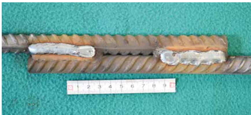
Fot. 2. Zakładkowe złącze spawane z prętów ze stali B600B o średnicy 16 mm
