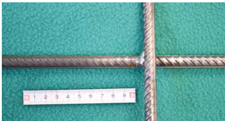
Fot. 3. Skrzyżowane złącze spawane wykonane z prętów ze stali B600B o średnicy 10 mm
