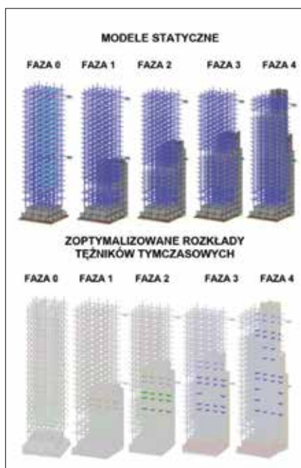
Rys. 7. Modele statyczne obrazujące fazy wznoszenia konstrukcji wraz z tężnikami tymczasowymi. Dla każdej z faz wznoszenia wykonano osobny model i stworzono obwiednię maksymalnych sił. Na podstawie uzyskanych wyników zoptymalizowano ilość i przekroje tężników tymczasowych
