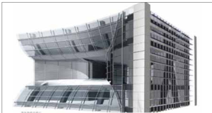
Rys. 7. Portal sprowadzający strumień wiatru w kierunku turbin, Pearl River Tower [17]
