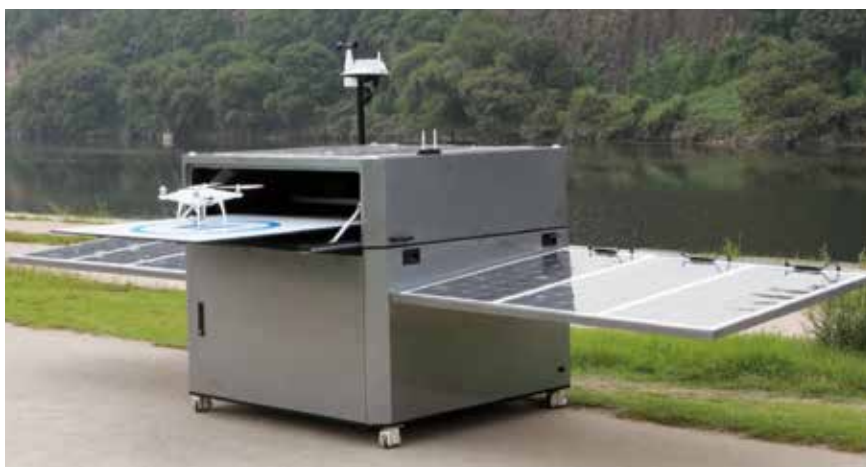
Fot. 1. Autonomiczna stacja dokująca dla drona, z systemem ładowania z paneli fotowoltaicznych
