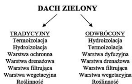
Rys. 2. Podział dachów zielonych ze względu na konstrukcję (źródło własne)
