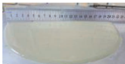
Betony wysokiej wytrzymałości jako elementy dekoracyjne i rozpliw zaprawy typu SCC z domieszką na bazie modyfikowanych lignosulfonianów
