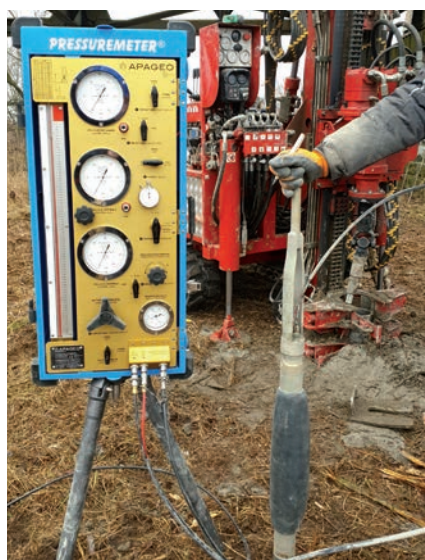
Fot. 5. Presjometr Menarda – po lewej panel kontrolno-pomiarowy, po prawej sonda wstępnie rozszerzona przed umieszczeniem w otworze; w tle przygotowany otwór wiertniczy
