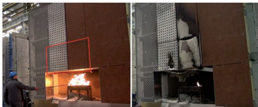
Fot. 6. Badania ogniowe elementów okładzinowych – przed i po badaniu (120 minut)
