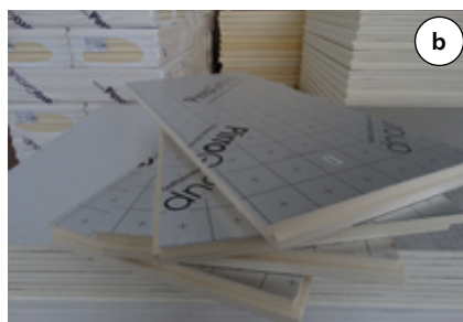
Fot. 1. Przykładowe materiały termoizolacyjne: a) płyty ze styropianu grafitowego, b) płyty PIR, c) płyty z wełny mineralnej
