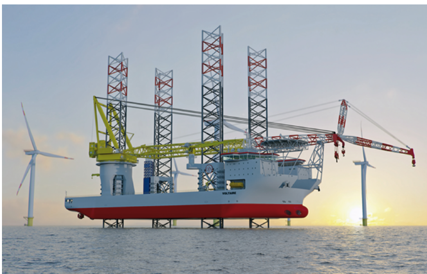
Fot. 5. Specjalistyczny statek nowej generacji do budowy elektrowni wiatrowych na morzu (źródło: materiały prasowe Jan De Nul Group)
