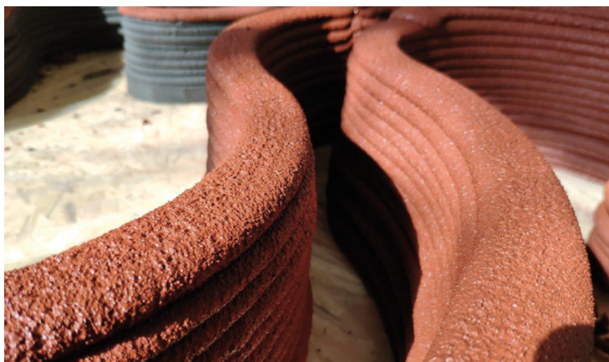
Fot. 5. Druk 3D z wykorzystaniem geopolimeru [6]
