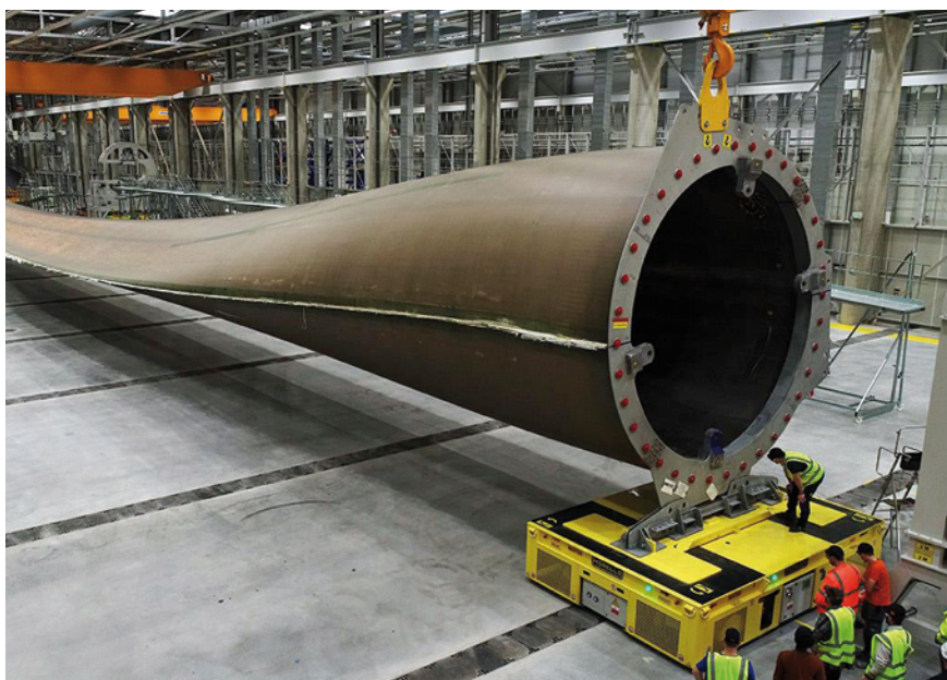
Fot. 3. Jedna z trzech łopatek turbiny wiatrowej Haliade-X 12 MW wyprodukowanej w zakładach LM Wind Power w Cherbourgu we Francji (źródło: materiały prasowe General Electric)
