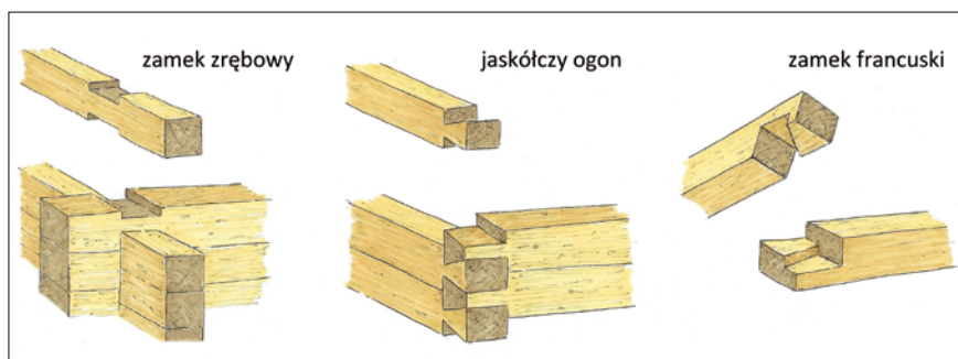
Rys. 1. Złącza ciesielskie stosowane w narożnikach budynku
