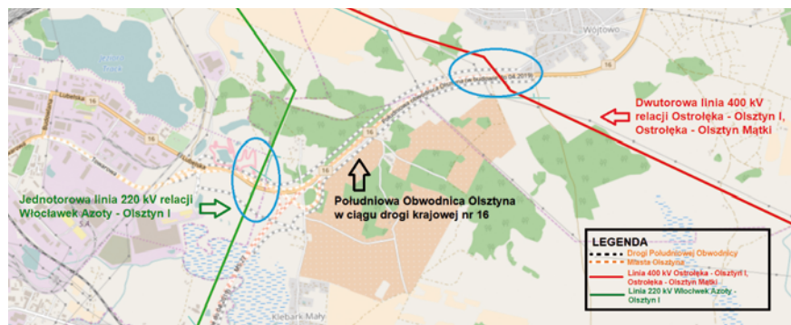
Rys. 1. Przykładowe miejsca kolizji przy skrzyżowaniach linii NN z Południową Obwodnicą Olsztyna
