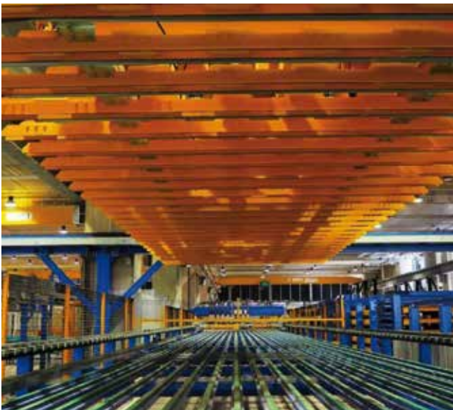
Fot. 2a. Automatyczna stacja do zgrzewania siatek zbrojeniowych firmy EBAWE [17]
