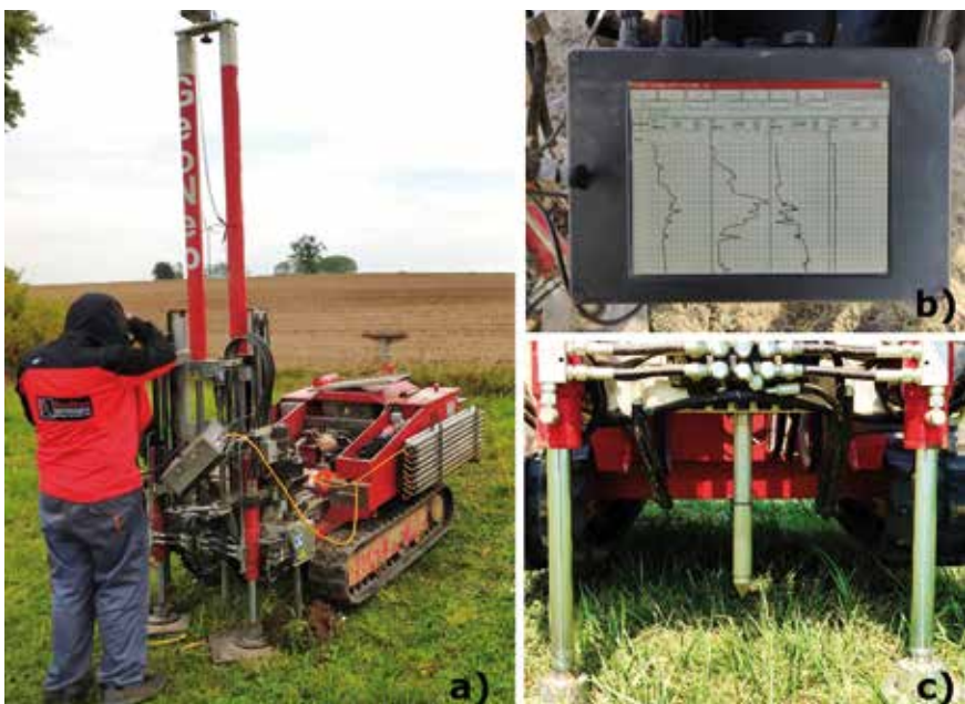
Fot. 1. Sondowanie CPTU: a) penetrometr samobieżny podczas pracy, b) monitor umożliwiający analizę danych w czasie rzeczywistym, c) stożek bezpośrednio przed wciśnięciem w grunt
