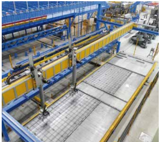
Fot. 2b. Zrobotyzowane centrum obróbki drutów stalowych firmy EBAWE [17]
