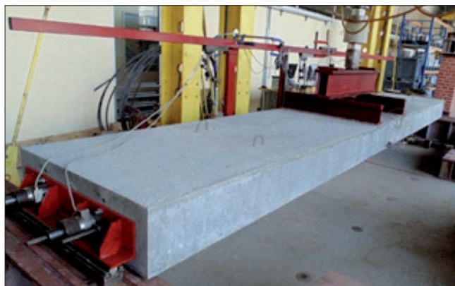
Fot. 3. Produkcja kablobetonowego elementu prefabrykowanego (źródło: materiały handlowe TCE)
