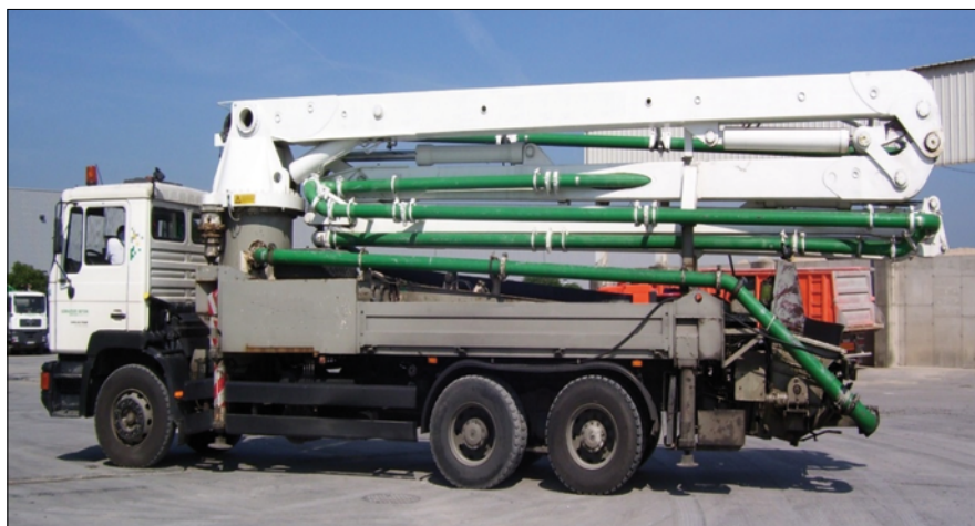
Fot. Pompa mieszanki betonowej z rurociągiem na podwoziu ciężarówki. Transport technologiczny to źródło największych emisji pośrednich w skali branży betonu towarowego
