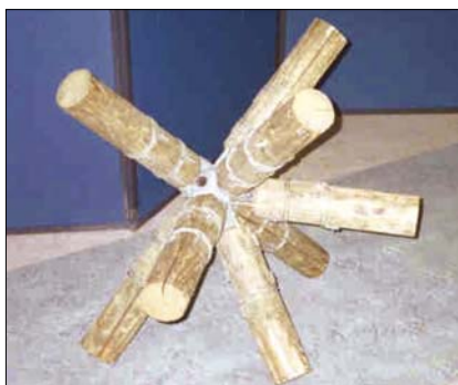
Fot. 21. Węzeł stalowy konstrukcji drewnianej – P. Huybers
