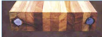
Fot. 7. Dźwigar drewniany zbrojony stalą
