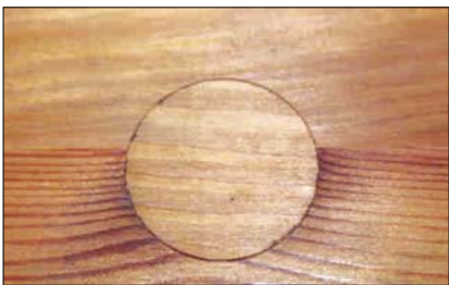
Fot. 4. Typowe usuwanie wad (sęków) w elementach drewnianych
