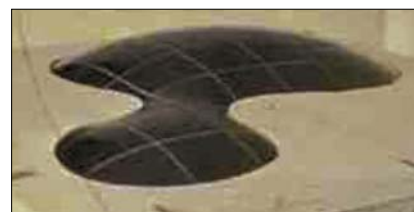
Fot. 26d. Model kształtujący powłokę żelbetową o skomplikowanym rzucie
