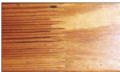
Fot. 22. Połączenie doczołowe kantówki drewnianej
