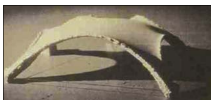
Fot. 25b. Model z rys. 25a – tkanina o kształcie utrwalonej zakrzepniętą żywicą
