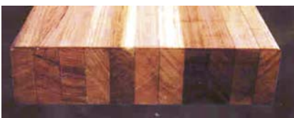
Fot. 5. Klejony dźwigar drewniany
