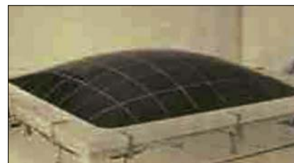
Fot. 26a. Model powłoki żelbetowej w stanie bezmomentowym – metoda Islera; membrana gumowa o kształcie wymuszonym nadciśnieniem powietrza
