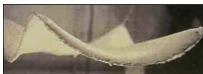
Fot. 25a. Eksperymentalne określenie kształtu powłoki żelbetowej w stanie bezmomentowym – metoda Islera
