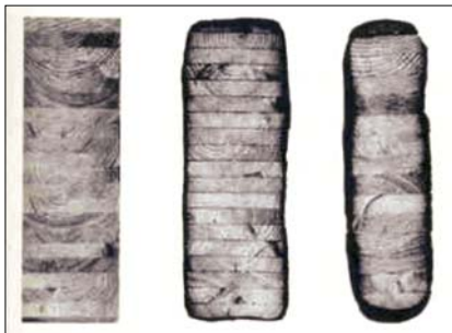
Fot. 6. Klejony dźwigar drewniany oraz po 30 minutach i po 60 minutach działania pożaru
