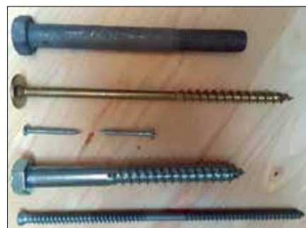
Fot. 2. Wielkość i kształt wybranych łączników trzpieniowych
