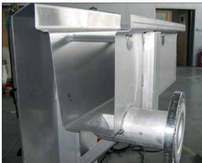
Fot. 11. Konstrukcja panelu koryta z odpływem niecki basenu ze stali nierdzewnej firmy Berndorf
