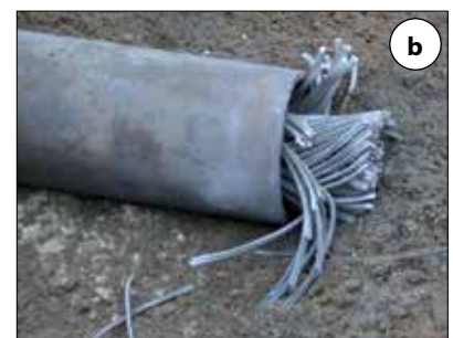
Fot. 2 | Lina 70 mm: a) przygotowana do cięcia wybuchowego, b) efekt cięcia
