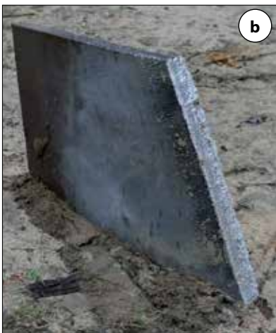
Fot. 1 | Blacha 30 mm: a) zainstalowany ładunek, b) efekt cięcia
