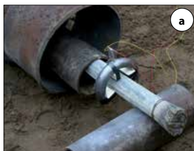
Fot. 2 | Lina 70 mm: a) przygotowana do cięcia wybuchowego, b) efekt cięcia
