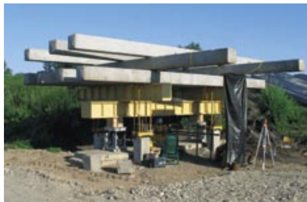
Fot. 6. Stanowisko do testu statycznego
