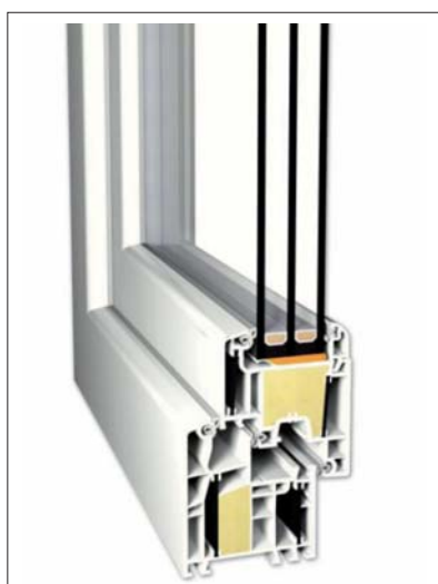
Rys. 7 | Dodatkowe wypełnienie profili ze wzmocnieniami kompozytowymi materiałem termoizolacyjnym pozwala na obniżenie współczynnika izolacyjności termicznej profili U_f nawet o 20%
