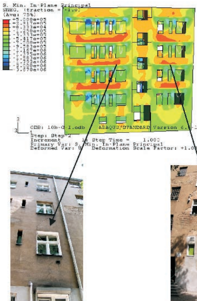
Rys. 11. Naprężenia minimalne ( \sigma_{\min} ) w tylnej ścianie elewacyjnej porównane z niektórymi strefami zarysowania tej elewacji
