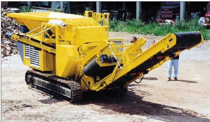
Fot. 4. Kruszarka na samojezdnym podwoziu gąsienicowym wyposażona w separator magnetyczny i system zdalnego odblokowania
