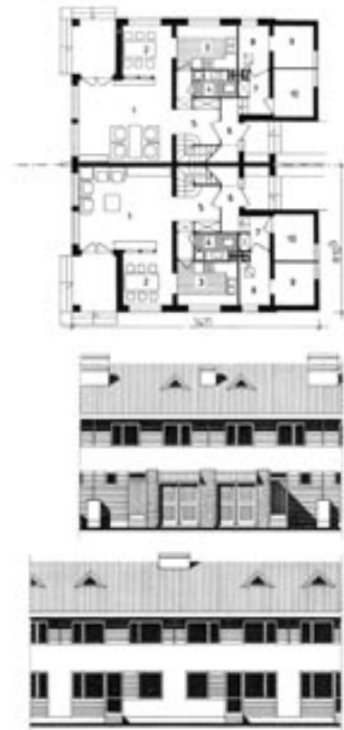
Dom bliźniaczy, niepodpiwniczony z poddaszem mieszkalnym bez garażu. Fundamenty betonowe, ściany zewnętrzne części nadziemnej warstwowe, strop DZ-3, dach o konstrukcji drewnianej, stolarka typowa, wyposażony w instalację wodociągową, kanalizacyjną, centralnego ogrzewania i elektryczną.
