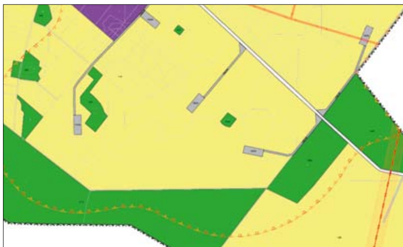
Rys. 1 | Mapa miejscowego planu zagospodarowania przestrzennego uwzględniająca lokalizację turbin wiatrowych z infrastrukturą, drogami dojazdowymi, placami montażowymi oraz strefą ochronną oddziaływania hałasu (źródło: archiwum WSB Parki Wiatrowe)
