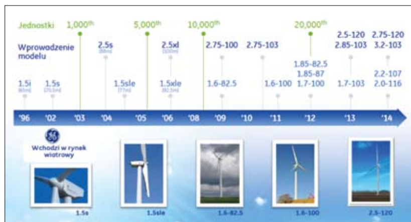
Rys. 5 | Przykład rozwoju modeli turbin wiatrowych na przestrzeni ostatnich lat (źródło: prezentacja o ewolucji produktów wiatrowych firmy GE)
