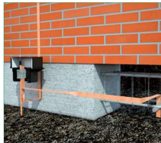
Rys. 4 | Prawidłowo wykonane połączenie uziomu sztucznego (system pomiedziowany Galmar) z uziomem fundamentowym
