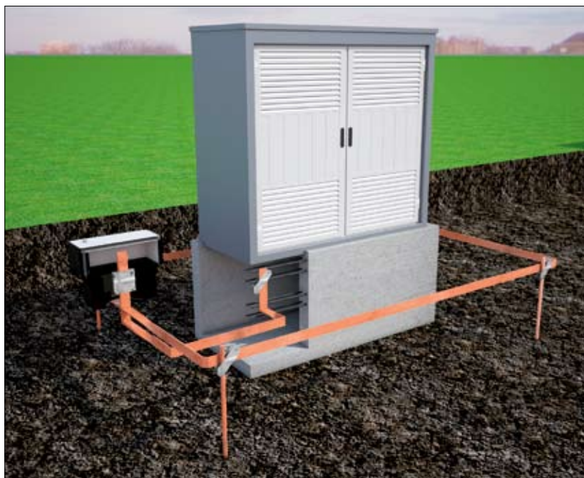
Rys. 2 | Złącze kontrolno-pomiarowe przeznaczone do cyklicznej kontroli stanu uziomu fundamentowego, np. w rozległych obiektach o konstrukcji stalowej (archiwum firmy RST)
